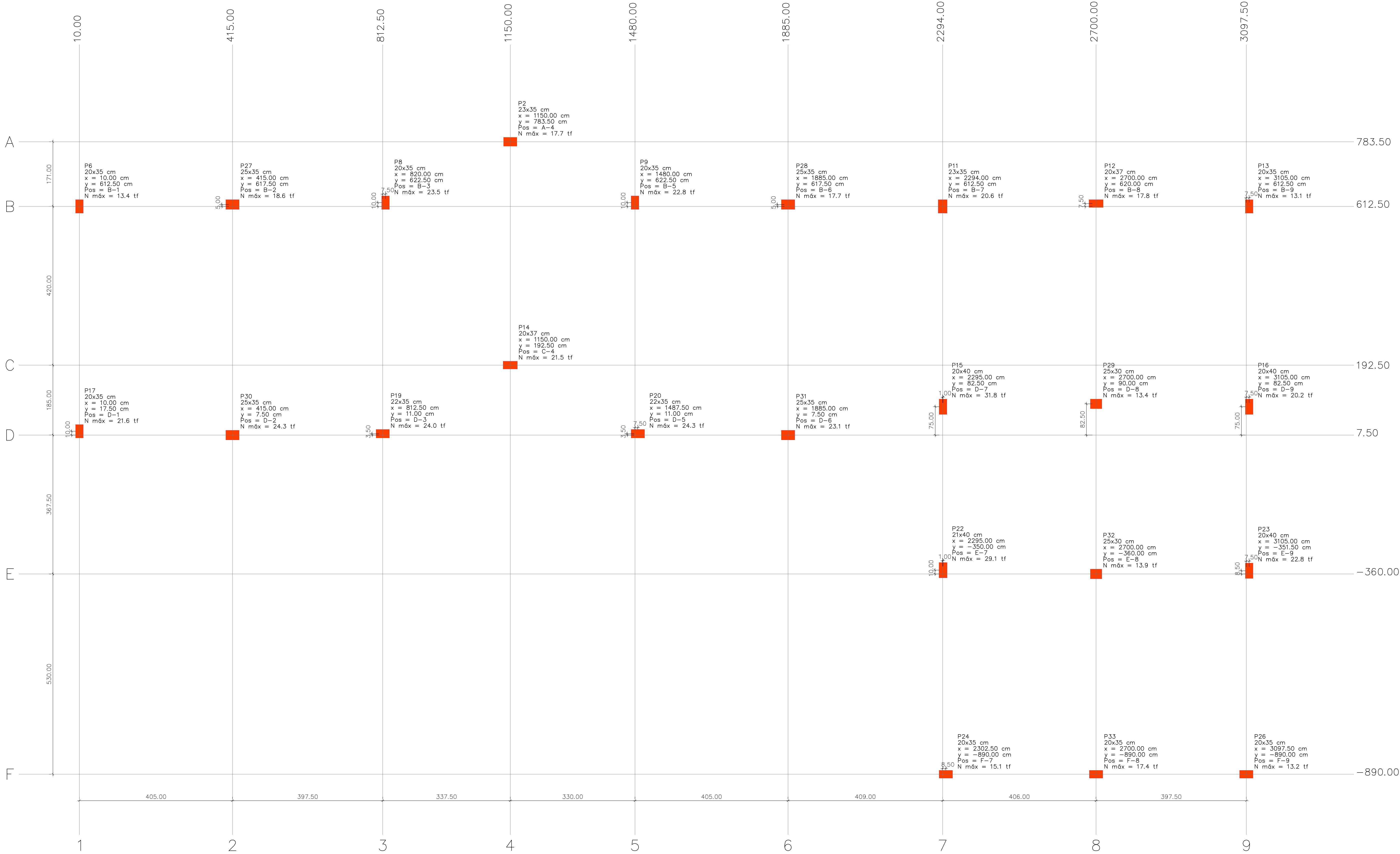
PLANTA DE CARGAS–Pilares Escala 1: 50
