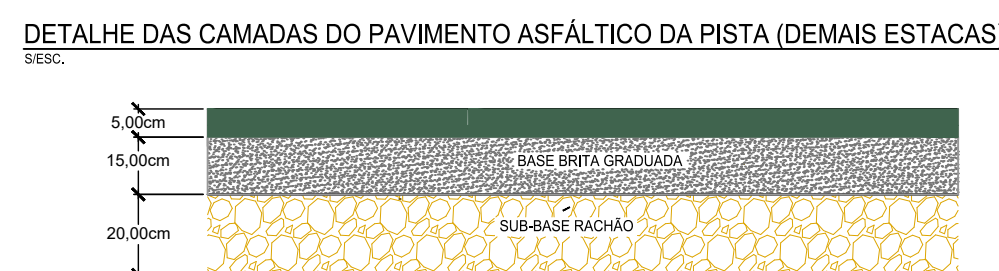
Diagrama de uma seção transversal de uma pista de concreto armado com 5 metros de largura. A seção mostra, de cima para baixo: 5,00 cm de concreto 15,00 cm de base brita graduada 20,00 cm de sub-base rachada 20,00 cm de reforço do subleito CBR=8, expansão=2 A largura total da pista é indicada como 5,00m no topo.
