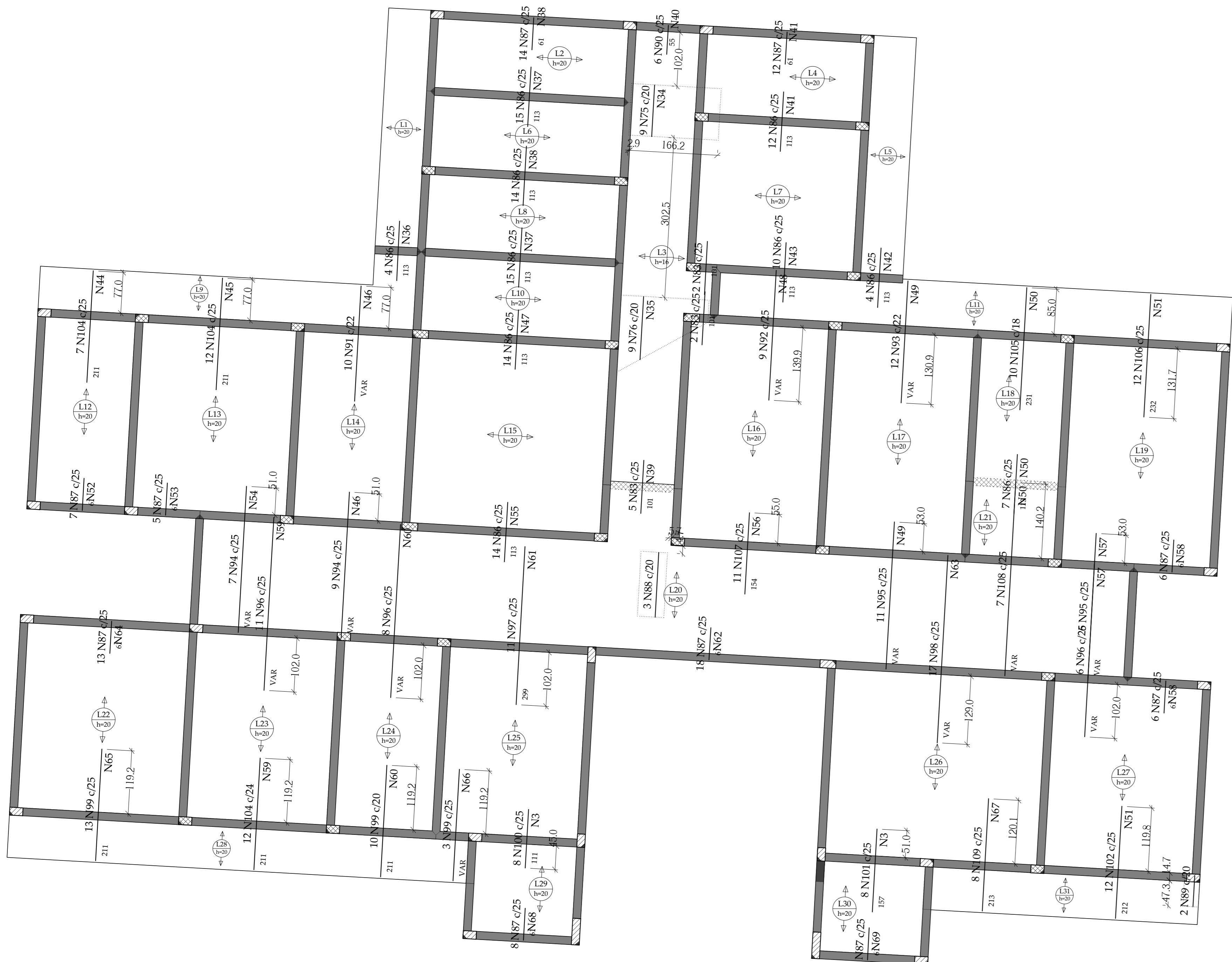
ARMAÇÃO NEGATIVA DAS LAJES DO PAVIMENTO TÉRREO (EIXO Y) ESC.: 1:50
