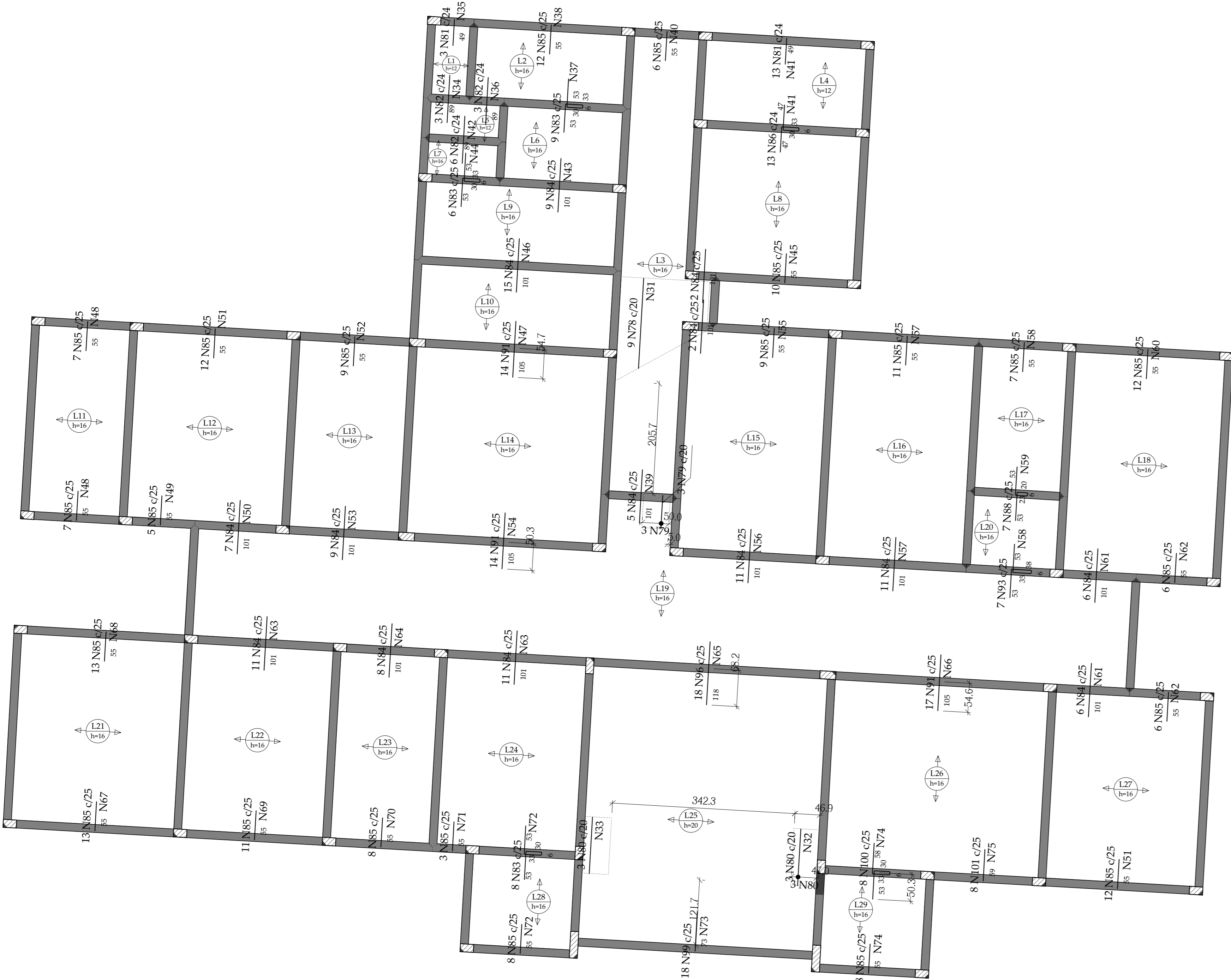
ARMAÇÃO NEGATIVA DAS LAJES DO PAVIMENTO BALDRAME (EIXO Y) ESC.: 1:50
