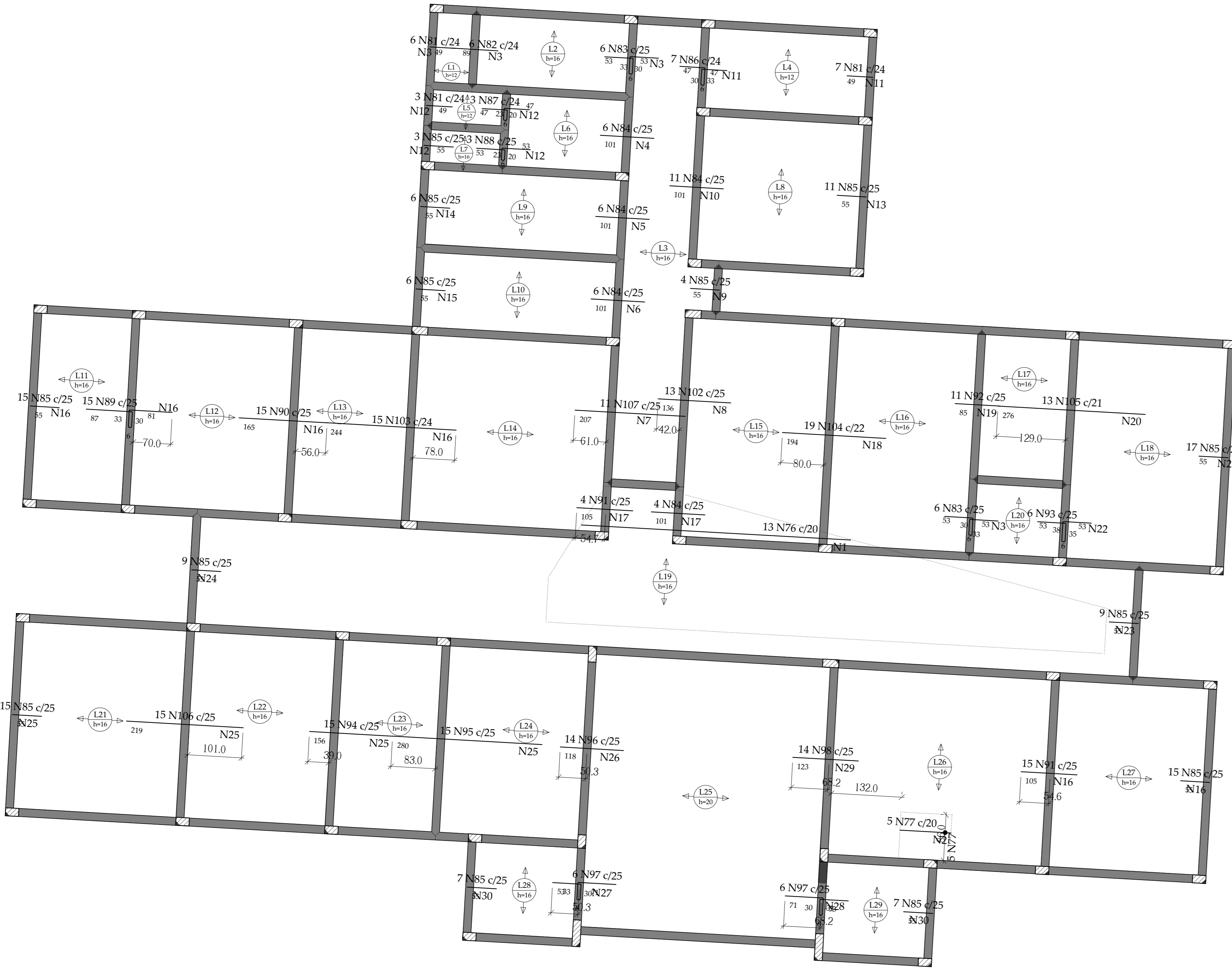
ARMAÇÃO NEGATIVA DAS LAJES DO PAVIMENTO BALDRAME (EIXO X) ESC.: 1:50
