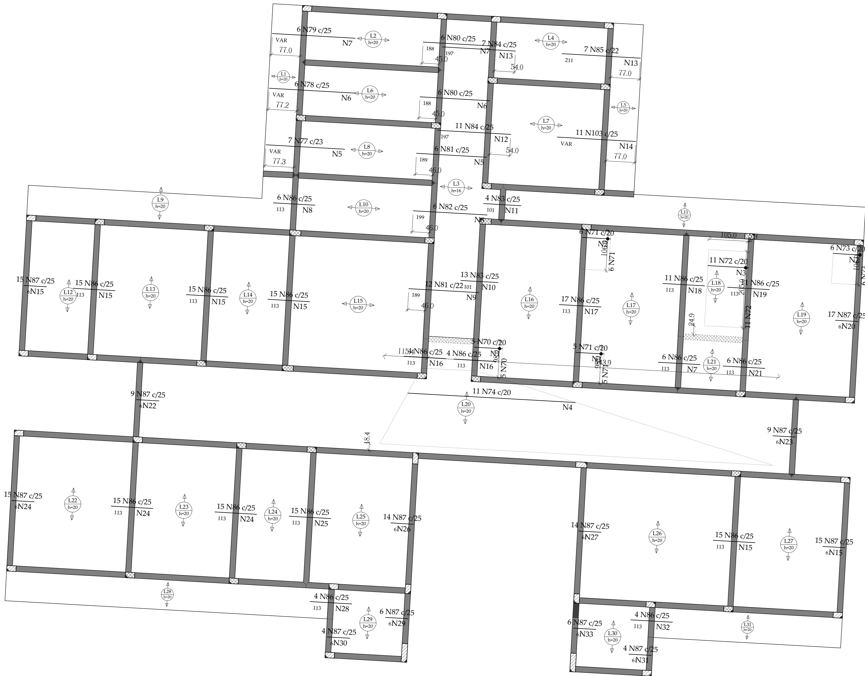
ARMAÇÃO NEGATIVA DAS LAJES DO PAVIMENTO TÉRREO (EIXO X) ESC.: 1:50
