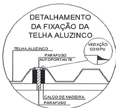
Imagem 08: Modelo de instalação, considerar telha tipo sanduíche e estrutura metálica.
