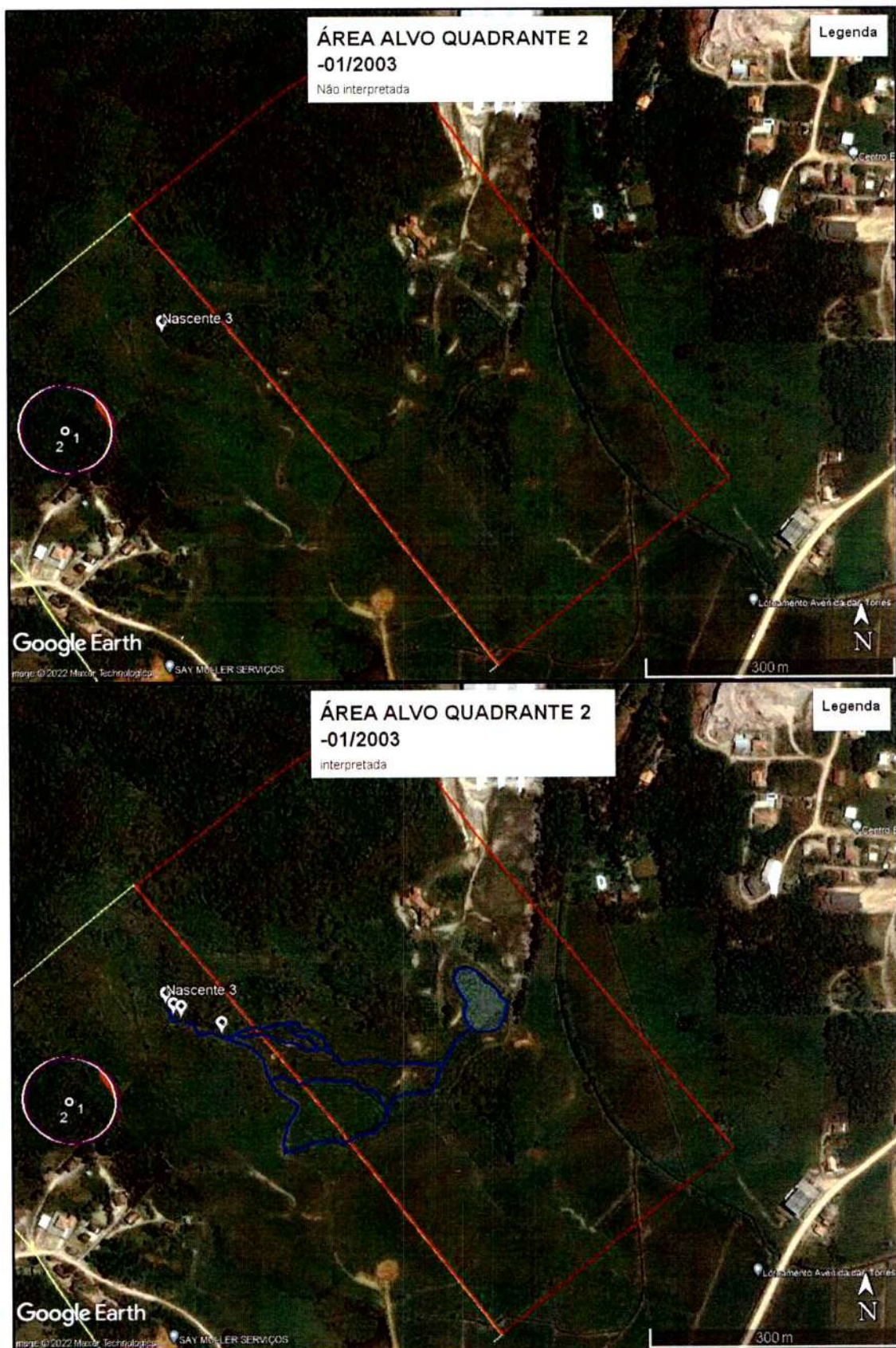
Figura 15 - Imageamento para o ano de 2003. Claramente havia na localidade, em virtude da declividade do terreno, várias disposições de talvegues que drenavam o curso proveniente da nascente até feição lagunar.
