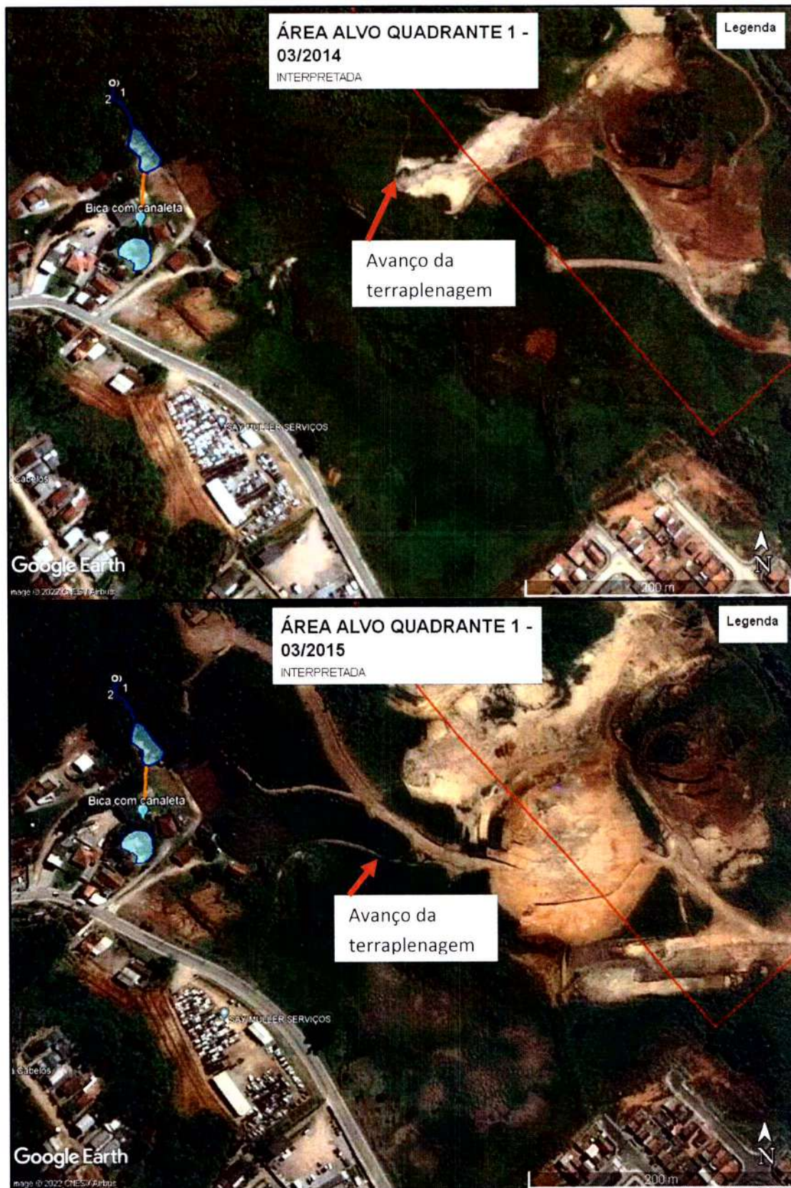
Figura 6 – Imageamentos 2014 e 2015 mostrando o avanço da terraplenagem no quadrante em análise.
